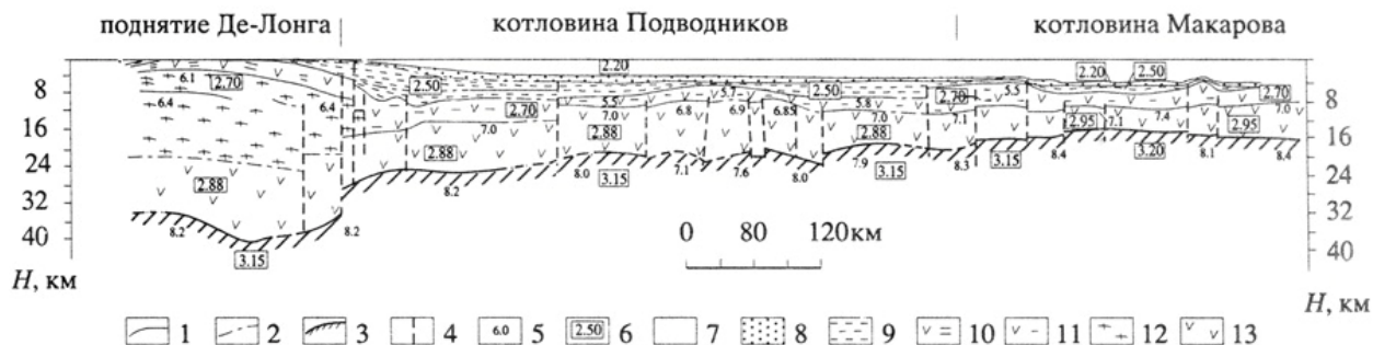
Рис. 1. Комплексная модель земной коры по геотраверзу о. Де-Лонга–котловина Макарова. 1, 2 – сейсмические границы: 1 – уверенные, 2 – неуверенные; 3 – поверхность верхней мантии; 4 – тектонические нарушения; 5 – скорость продольных волн, км/с; 6 – плотность пород, г/см 3 ; 7 – водный слой; 8 – верхняя осадочная толща (1.6 – 2.8 км/с, мел–кайнозой); 9 – средняя осадочная толща (3.7 – 5.3 км/с, мезозой); 10 – осадочно-вулканогенные отложения на поднятии Де-Лонга; 11 – нижняя, вулканогенно-осадочная толща осадочного слоя глубоководных котловин (5.5 – 5.8 км/с); 12 – гранитно-метаморфический слой; 13 – “базальтовый” слой.
