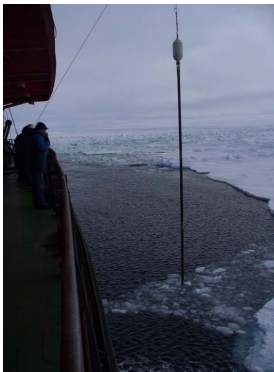
Рис. 3. Вакуумная грунтовая трубка с глубиной отбора керна 10 м.
