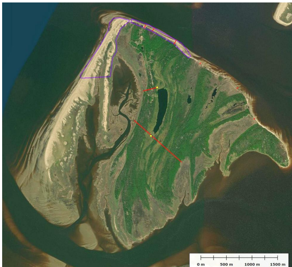
Рис. 4. Остров Кумбыш. Фиолетовым контуром обозначены участки аэрофотосъёмки с БПЛА; красные линии - геодезические (DGPS) профили, по северо-восточному берегу совпадающие с разрезами в клифах и местами отбора радиоуглеродных образцов; жёлтыми точками обозначены скважины ручного бурения.
