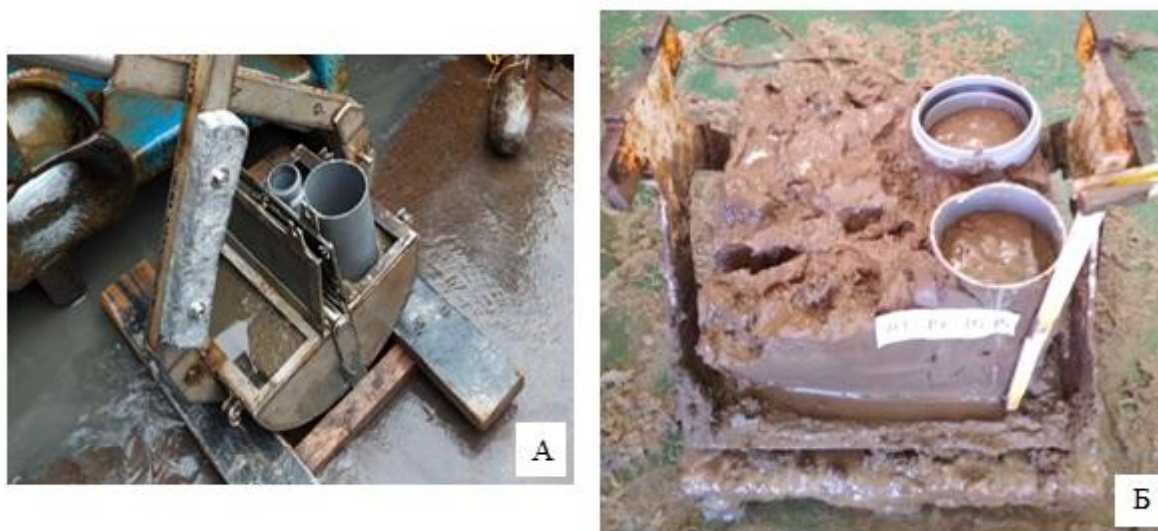
Рис. 1. Орудия отбора проб: А – дночерпатель Ван-Вина; Б – бокс-коррер
