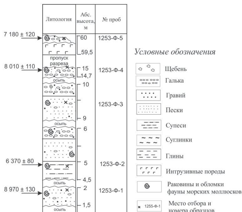
Рис. 3. Разрез голоценовых отложений на о. Вильчека в т.н. 1253. Слева от литологической колонки показаны радиоуглеродные датировки.
