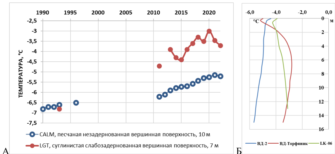
Рис. 4. Средняя годовая температура пород на НИС «Васькины Дачи» с 1990 г. (А) и за «гидрологический» 2022 г. (Б), где ВД-2–задернованная вершинная поверхность с супесчано-глинистыми породами; ВД-торфяник–водораздельная поверхность в пределах полигонального торфяника мощностью торфа 1,3 м; LK-06–слабодренированная склоновая поверхность с мощностью торфа с прослоями песков 1,3 м
